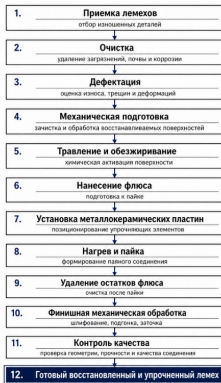
Рисунок 9 - Структурная схема технологического процесса восстановления и упрочнения
