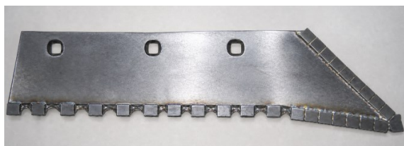
Рисунок 9 - Внешний вид опытного образца, упрочнённого металлокерамическими пластинами, после эксплуатационных испытаний
